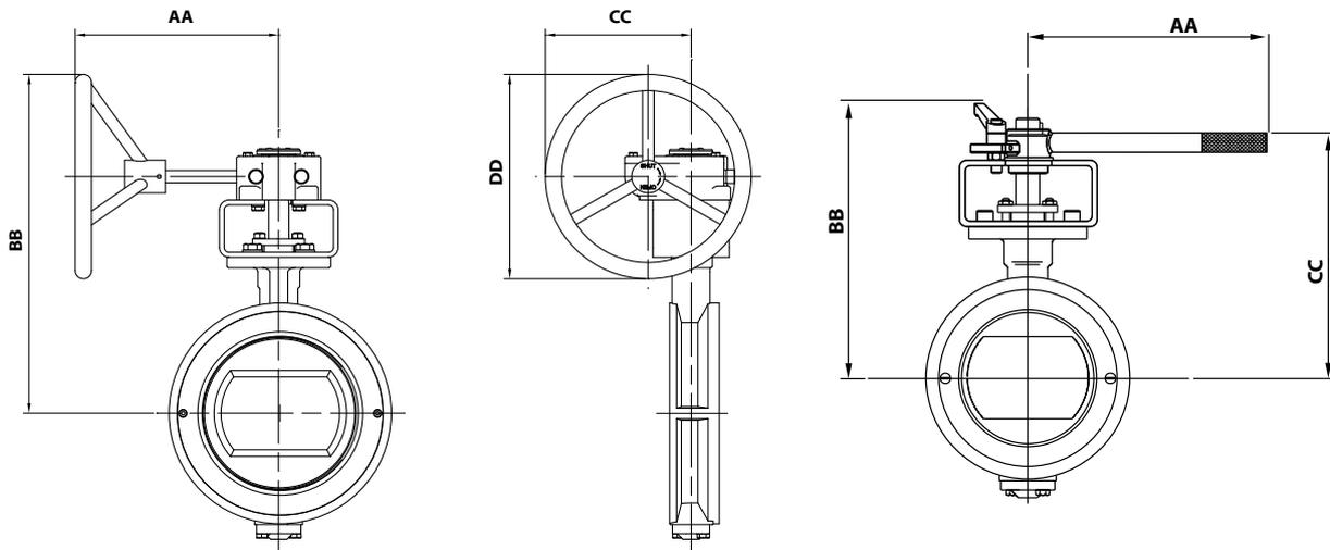
**Regel- und Absperrklappen MTV mit Schneckengetriebe**
