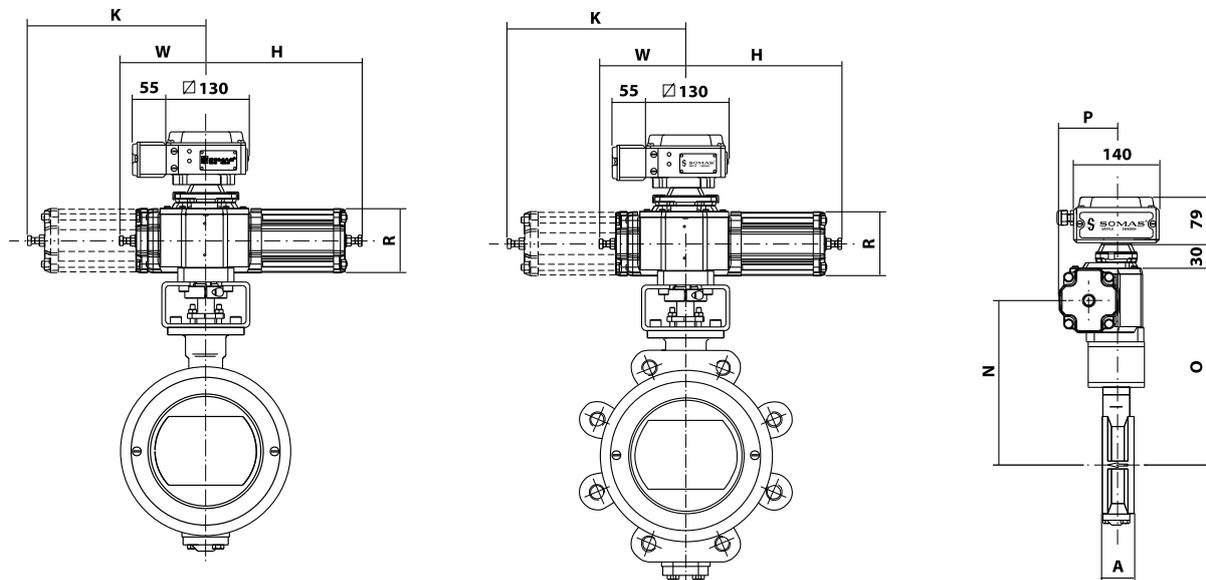
Regel- und Absperrklappen Typ MTV/MTVL/MTVF mit Stellantrieb Typ A-DA
